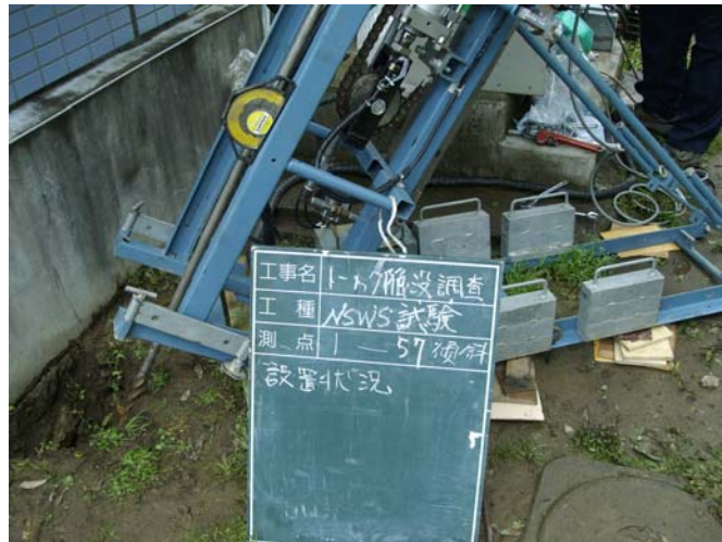
写真-4 NSWS による傾斜測定
